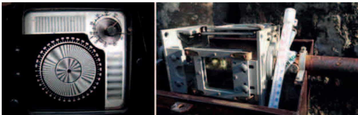
Rys. 11. Przykład prążków interferencyjnych zarejestrowanych szczelinomierzem TM71 i widok jego konstrukcji na stanowisku pomiarowym
